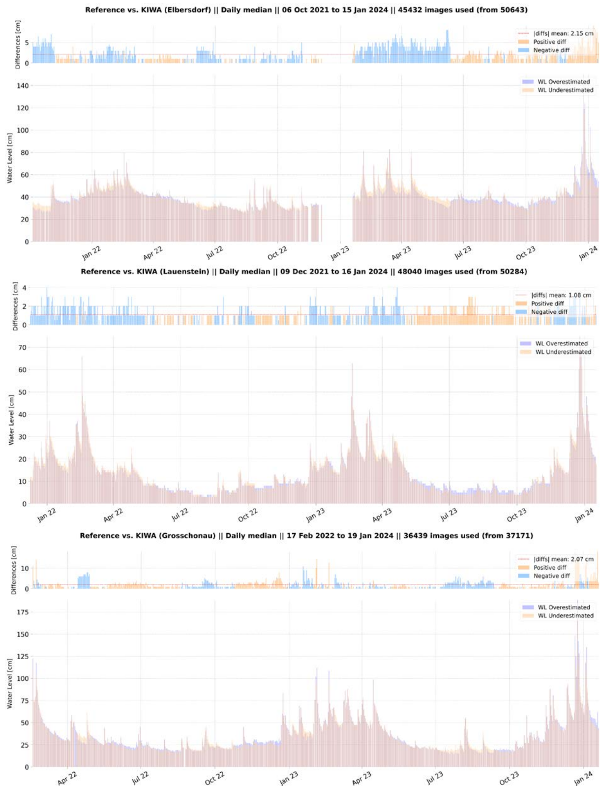
Abbildung 25: Vergleich der Tagesmittelwerte des Wasserstandes der optischen Messung mit der Referenz für die Messstellen Elbersdorf (oben), Lauenstein (Mitte) und Großschönau (unten)
