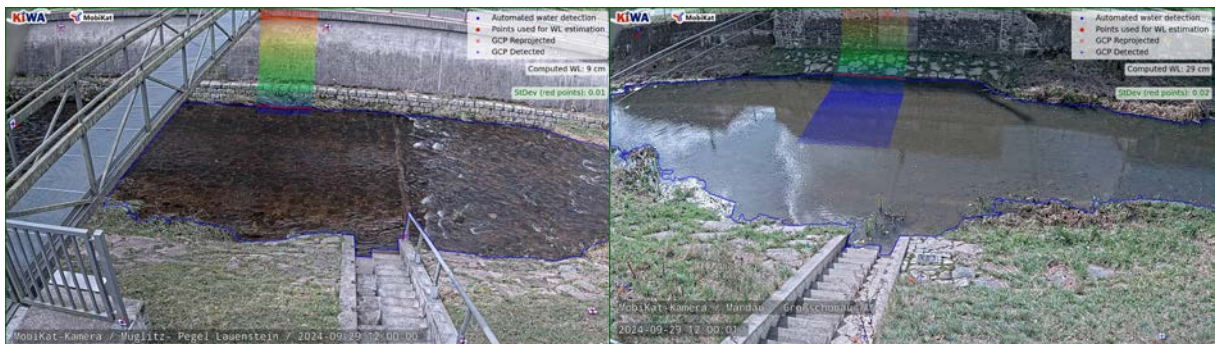
Abbildung 39: Operationell ermittelte Wasserstände der KI-W für die Messstellen in Lauenstein (links, 9 cm) und Großschönau (rechts, 29 cm) am 29.09.2024, 12:00Uhr
