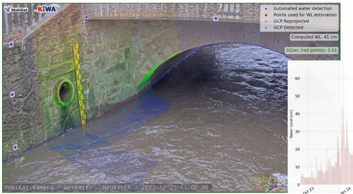
Abbildung 26: Optische Wasserstandsmessung an der Messstelle Typ B in Neukirch mit zugehöriger Ganglinie
