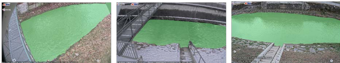
Abbildung 11: Kamerabilder mit manuell segmentierten Wasserflächen aus dem Trainingsdatensatz für die KI zur automatischen Wasserflächensegmentierung
