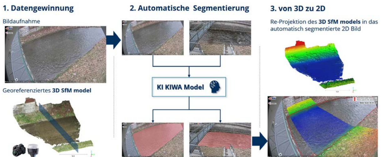
Abbildung 13: Arbeitsablauf für die Wasserstandsermittlung bestehend aus (1) Datengewinnung, (2) automatische Segmentierung der Wasserfläche mittels KI und (3) der Rückprojektion des 3D-Modells in das segmentierte 2D Bild
