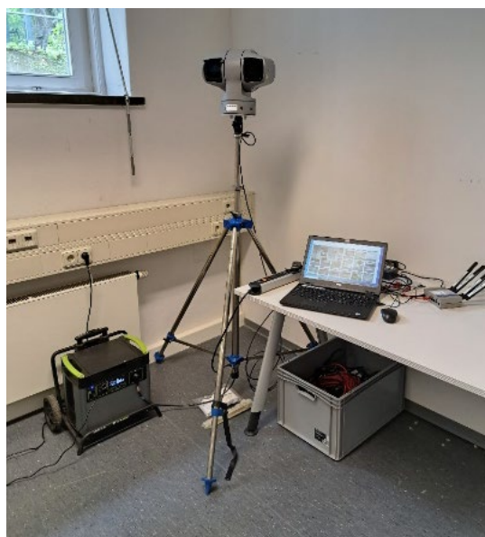
Abbildung 16: Labortest zum Stromverbrauch mit GoalZero Yeti 3000x, Axis Q6215 und Laptop
