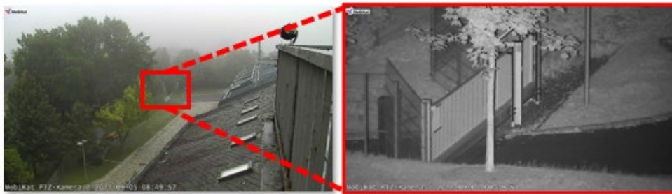
Abbildung 17: Test der Bildqualität und IR-Strahlerleistung mit Axis Q6215
